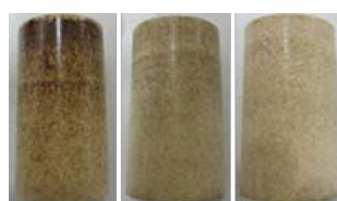
1300 1100 900 密度 (kg/m 3 ) 高密度バイオマス ブリケット外観
