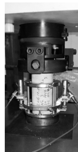
写真1.2 コンクリート 圧縮強度試験
