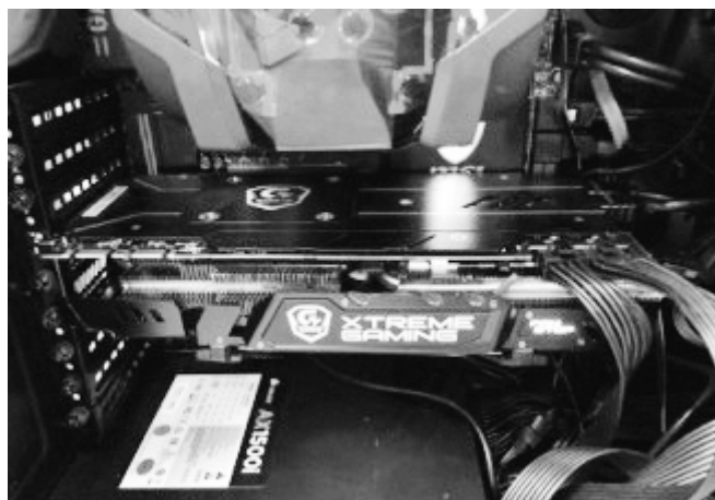
図3. GPU ボード搭載マシン——ディープラーニングのアクセラ レーション用——
