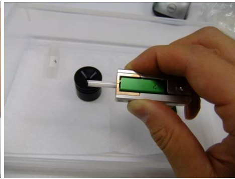
②治具を握りつつサンプル管を左側に動かすと、治具が羽とサンプル管の間にはまる
