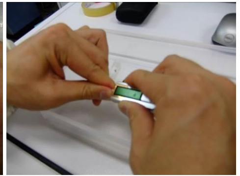
③サンプル管を軽くねじりつつ、羽を引き抜く(斜めに力を加えぬよう注意)
