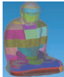
図2 鎌倉大仏耐震解析モデル
