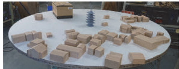
写真2 法華経寺五重塔とその周辺の環境の風洞実験用模型
