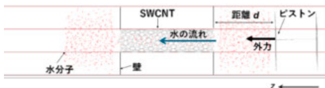
図 1. SWCNT による水輸送の MD 計算モデル。SWCNT のチューブ軸方向を z 軸とした。水分子には SPC/E モデル[4]を用いた。
