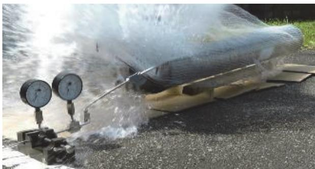
図 2 耐圧試験における破裂の様子
