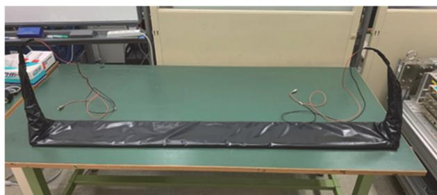
図 2 完成した試作 TOF カウンタ[10]
