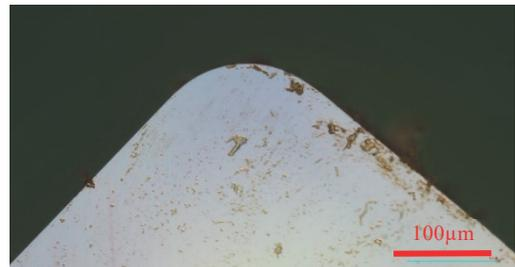
図 3 ダイヤモンド工具先端刃先の顕微鏡写真
